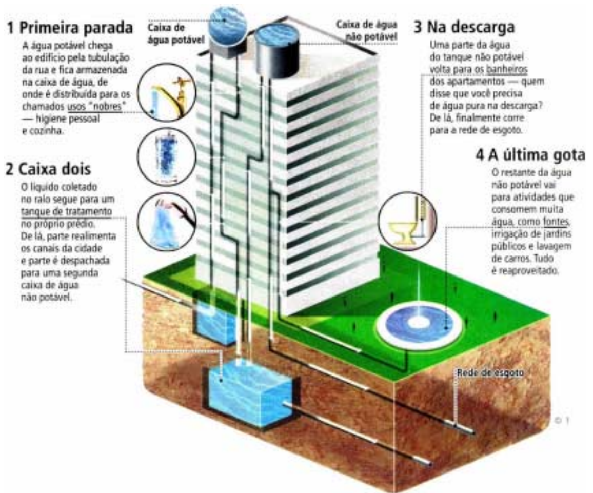
Figura 3: Exemplo de um prédio projetado para a economia de água 2
